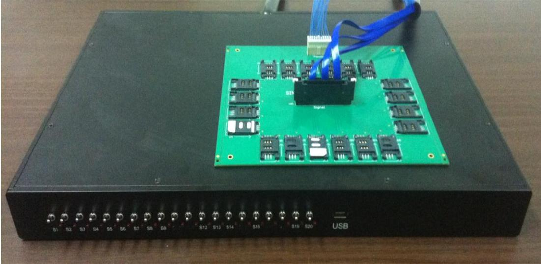
图 1 QTG20-C 接触卡可靠性测试系统产品外观
